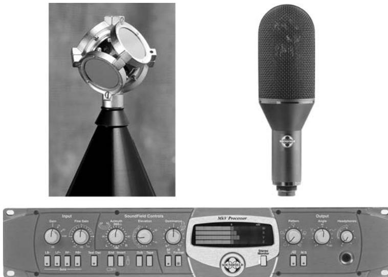
**Abb. 10.36** Soundfield-Mikrofonsystem. Oben: Anordnung der vier Mikrofonkapseln zur Aufnahme im A-Format (Left Front LF, Right Front RF, Left Back LB und Right Back RB) und geschlossenes Mikrofongehäuse. Unten: Controller zum Processing der A-Format-Signale (Fotos: Soundfield Ltd.)
