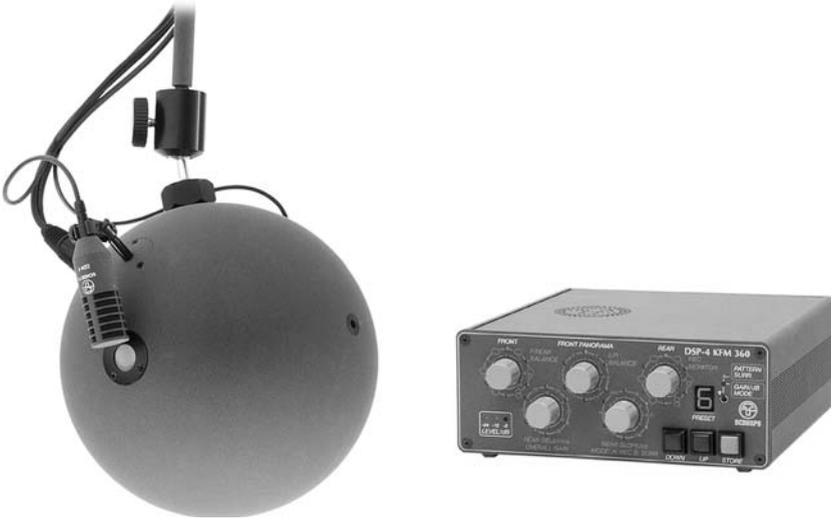
Abb. 10.42 Kugelflächenmikrofon KFM 360 mit aufgesetzten Gradientenempfängern in Achtcharakteristik und Steuereinheit zur Matrizierung und Entzerrung der Mikrofonensignale (Fotos: Fa. Schoeps Mikrofone)
